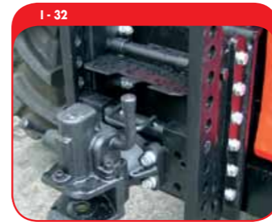
I - 32 ADJUSTABLE SLIDING HOOK ENGATE AJUSTÁVEL DESLIZANTE GANCHO RESBALANTE AJUSTABLE
