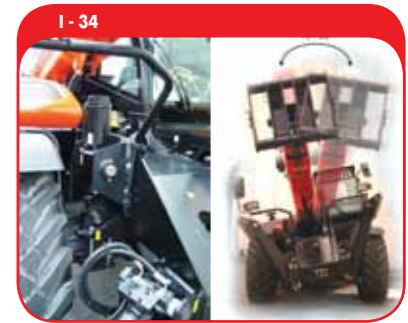
I - 34 HORIZONTAL LEVELLING DEVICE (+ - 10°) DISPOSITIVO DE NIVELAMENTO TRANSVERSAL (+ - 10°) DISPOSITIVO NIVELACIÓN TRANSVERSAL (+ - 10°)
