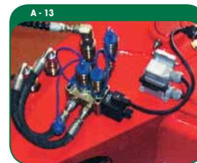
A - 13 DOUBLE PLUG MANUAL OR ELECTRIC AL DOUBLE EFFECT ON THE HEAD BOOM TOMADA MANUAL DUPLA OU ELÉTRICA COM EFEITO DUPLO NA PONTA DO BRAÇO DOUBLE ENCHUFE MANUAL O ELECTRICA A DOBLE EFECTO EN EL FINAL DE LA PLUMA
